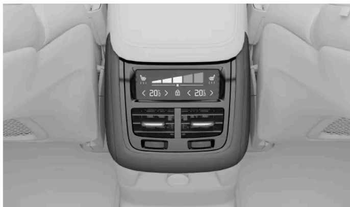
Comandos de climatização na consola de túnel
