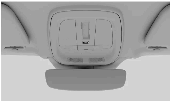
O botão das luzes automáticas desligadas na consola do teto
