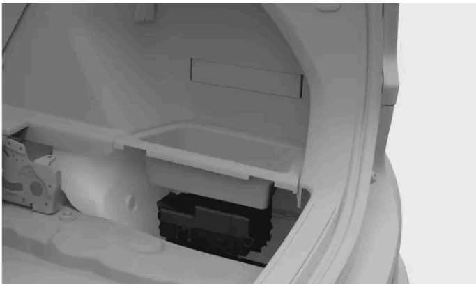
Localização da caixa de fusíveis
