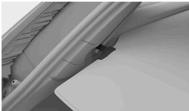
Levante e puxe a extremidade da tela da cobertura de carga pela pega para a desbloquear. Isto permite a retração da tela de carga.
