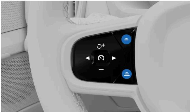
Ajuste a duração de passagem aos veículos na frente utilizando os botões do volante.
