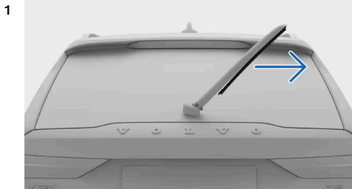
Segure no centro do braço do limpa-vidro e levante-o afastando-o do vidro traseiro. Pode sentir alguma resistência a meio do trajeto – esta é a posição de bloqueio. Tem de puxar o braço do limpa-vidro para além da posição de bloqueio para que este não caia de volta sobre o vidro traseiro.
