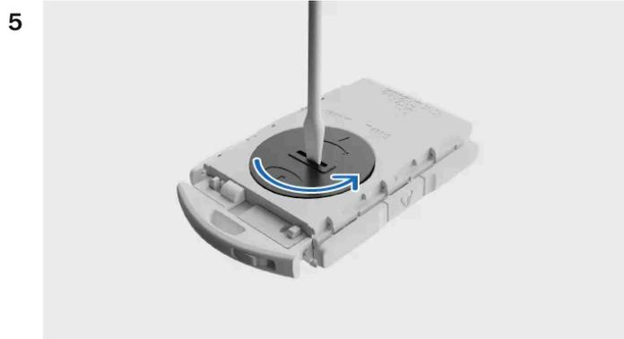
Utilizando uma ferramenta adequada, como uma chave de fendas ou uma moeda, rode a tampa da pilha no sentido contrário ao dos ponteiros do relógio para a libertar.
