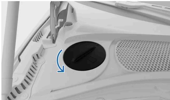
Abra a portinhola do painel no canto superior esquerdo do compartimento do motor para aceder ao reservatório do líquido de arrefecimento.
