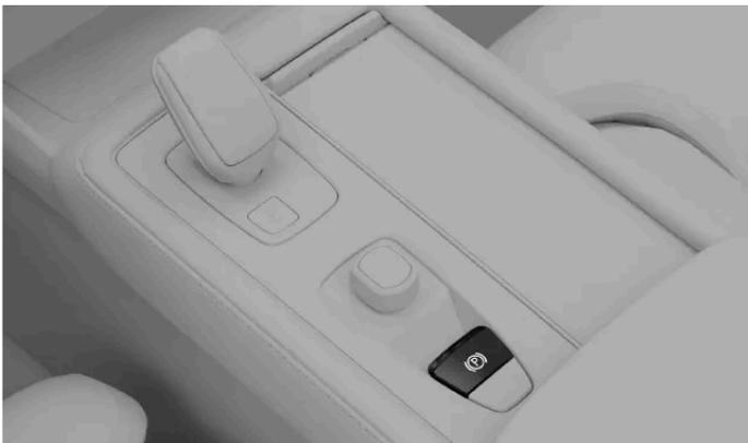
Acione manualmente o travão de estacionamento puxando o interruptor do travão de estacionamento.
