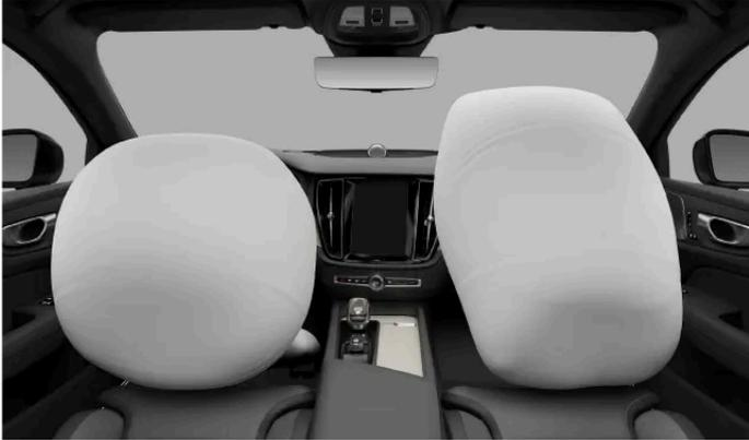
O lado do condutor tem dois airbags dianteiros. O airbag superior encontra-se acondicionado no interior do volante e o airbag do joelho atrás de um painel sob o volante.
