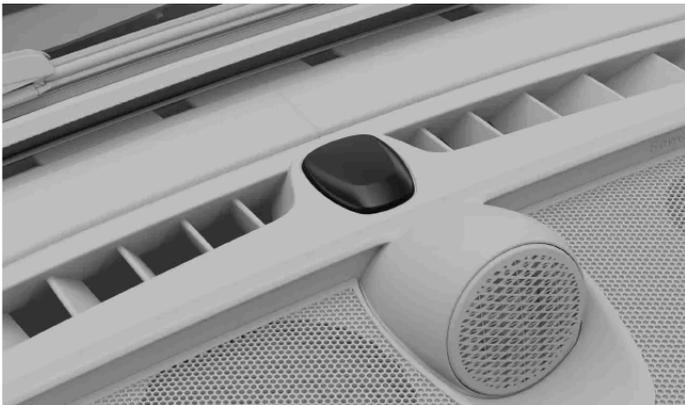
O indicador do alarme é uma luz situada no centro do tablier, mesmo em frente do para-brisas. O indicador confirma quando o alarme está ativado com uma luz vermelha a piscar.
