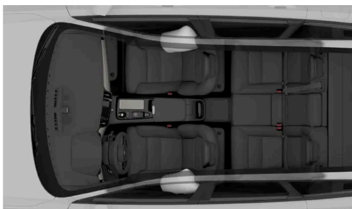
Airbags de colisão lateral para os ocupantes dianteiros.
