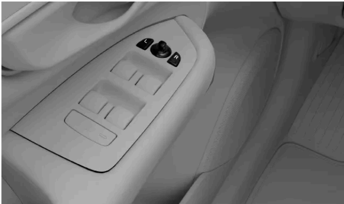
Comandos para ajuste dos retrovisores laterais
