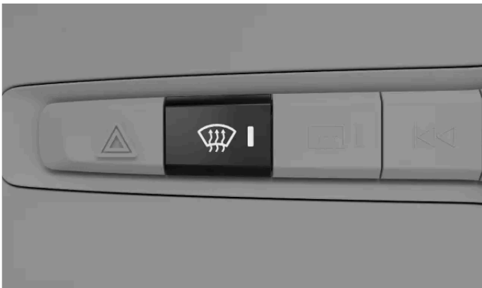
Botão do degelador máximo no painel de botões sob o mostrador central
