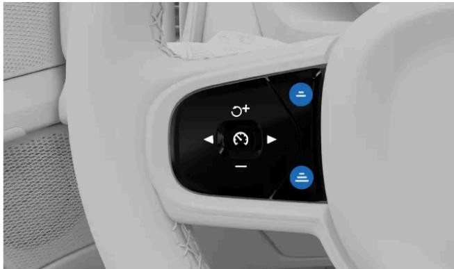
Ajuste a duração de passagem aos veículos na frente utilizando os botões do volante.
