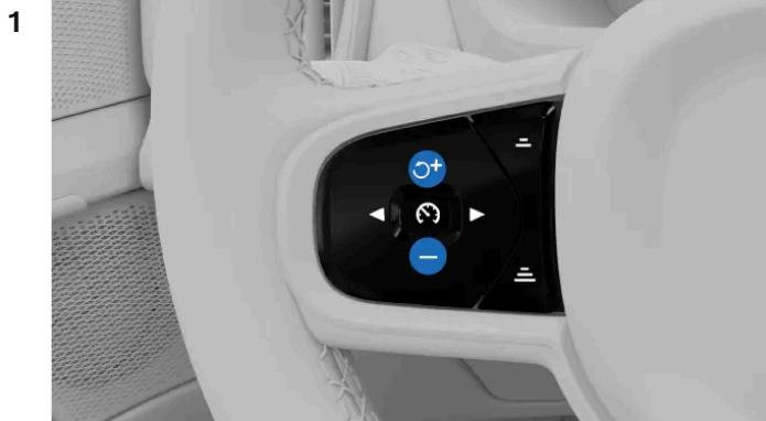
Ajuste a velocidade-alvo utilizando os botões no volante.
