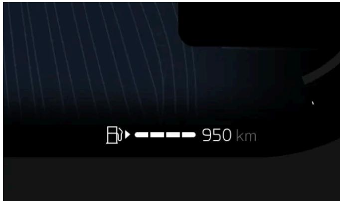
A sua autonomia está relacionada principalmente com a quantidade de combustível que resta no depósito do seu automóvel e com as suas práticas de condução, mas as condições externas também podem ser um fator. O indicador de combustível e a autonomia esperada são apresentados no mostrador do condutor.
