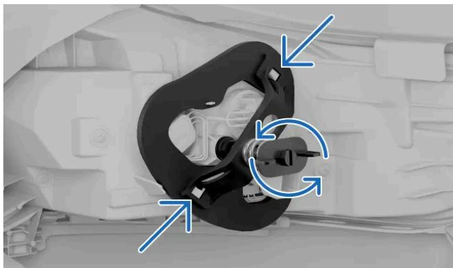
Desaperte o parafuso de mola rodando-o no sentido contrário ao dos ponteiros do relógio. Deixe o parafuso na ponte de apoio para que o possa encontrar quando precisar dele novamente.
