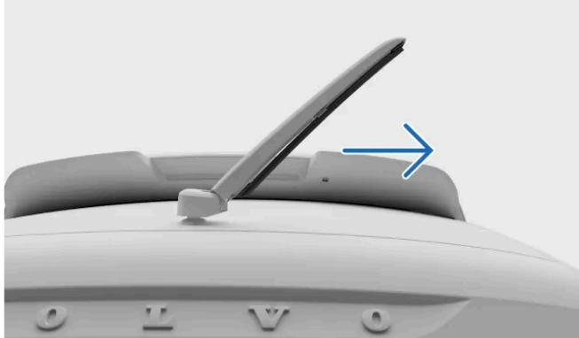
Segure no centro do braço do limpa-vidro e levante-o afastando-o do vidro traseiro. Pode sentir alguma resistência a meio do trajeto – esta é a posição de bloqueio. Tem de puxar o braço do limpa-vidro para além da posição de bloqueio para que este não caia de volta sobre o vidro traseiro.
