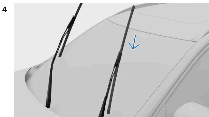
Assegure-se de que a escova do lado do condutor é mais comprida do que a do lado do passageiro. Deslize a escova do limpador de para-brisas no braço do limpador de para-brisas. Assegure-se de que o pino no braço do limpador de para-brisas entra no orifício da escova do limpador de para-brisas. Empurre a escova no braço do limpador de para-brisas até escutar um estalido.
