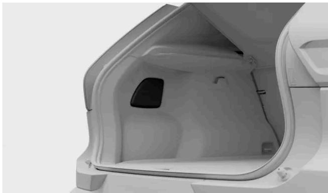
Prima a extremidade superior da tampa do painel para a fazer rodar e retire-a.
