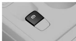
Acione manualmente o travão de estacionamento puxando o interruptor do travão de estacionamento.
