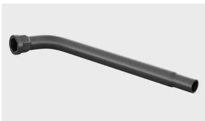
Ao substituir uma roda, necessita da chave para desapertar ou apertar os retentores das rodas. O olhal de reboque pode ser apafusado na chave de rodas para aumentar o braço da alavanca.
