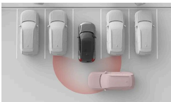
O seu automóvel pode detetar um outro automóvel a cruzar na sua traseira, por exemplo: durante a marcha-atrás para sair de um lugar de estacionamento. Isto permite avisá-lo para que possa abrandar ou travar.
