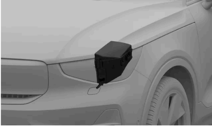
Localização da caixa de fusíveis
