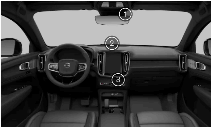
Os sensores da climatização interior
