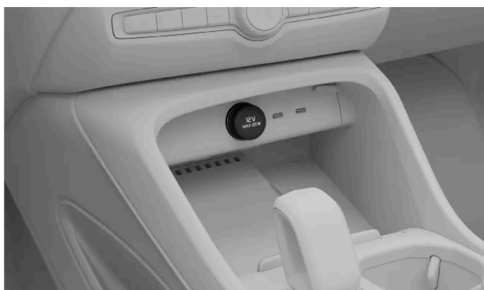
A tomada elétrica de 12 V na consola de túnel
