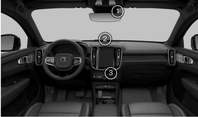
Os sensores da climatização interior
