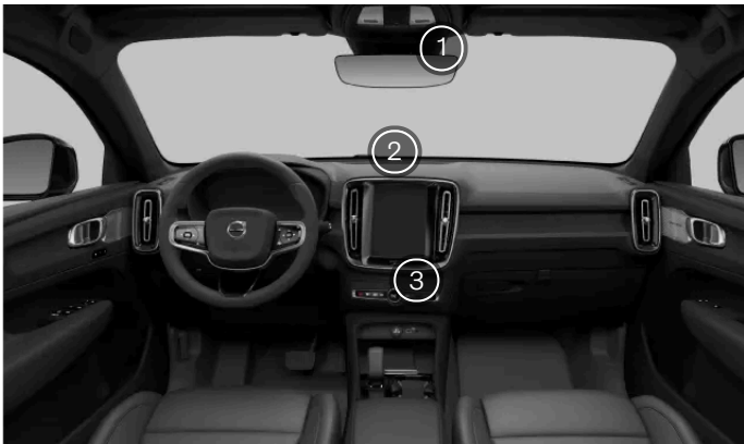
Os sensores da climatização interior
