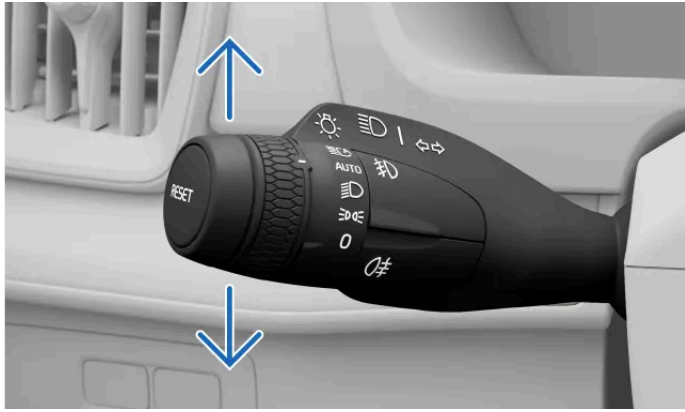
Os indicadores na alavanca do lado esquerdo
