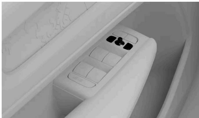
Comandos para ajuste dos retrovisores laterais
