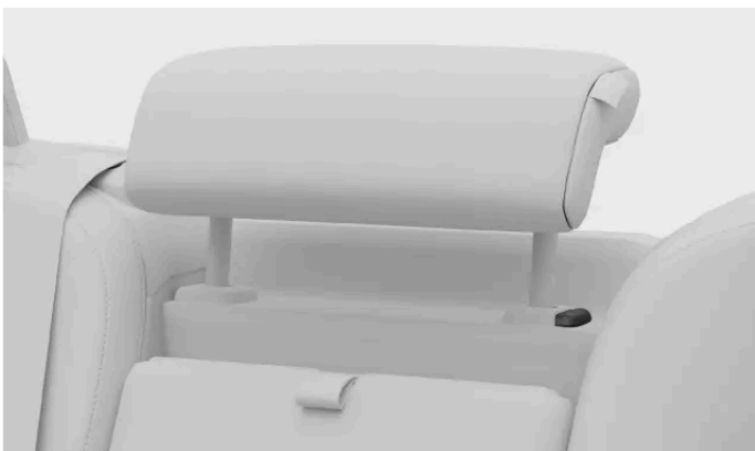
Botão de bloqueio no encosto da cabeça
