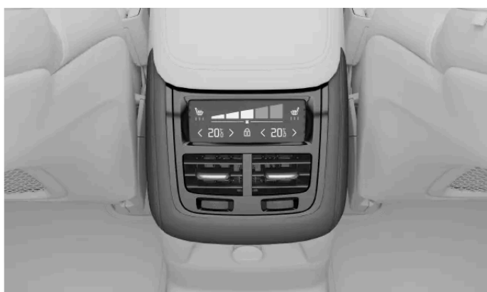
Comandos de climatização na consola de túnel
