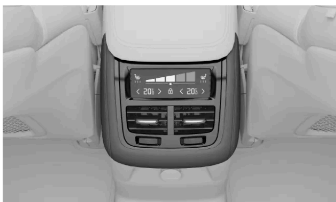
Comandos de climatização na consola de túnel
