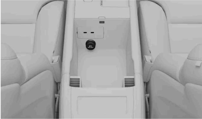
A tomada elétrica de 12 V na consola de túnel
