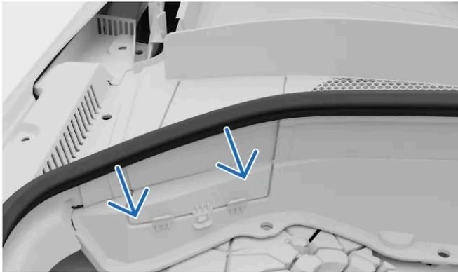
O reservatório do líquido de arrefecimento está localizado no canto superior esquerdo do compartimento do motor, sob uma portinhola do painel. Puxe o vedante de borracha na direção do compartimento do motor para aceder à portinhola.
