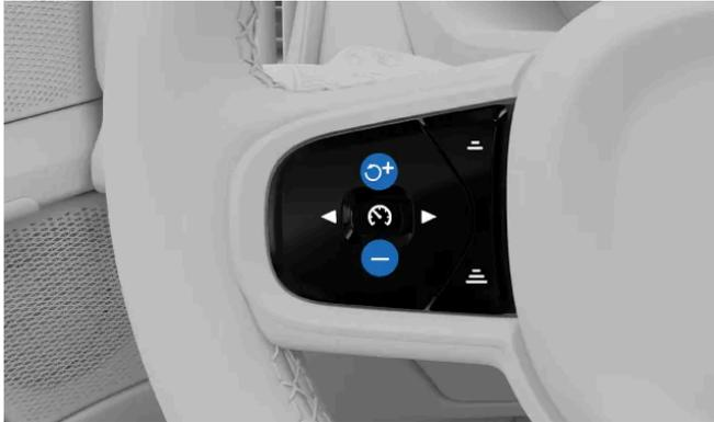
Ajuste a velocidade-alvo utilizando os botões no volante.
