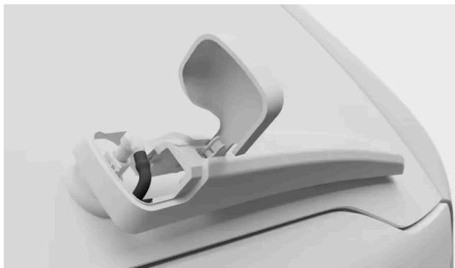
Procura a cobertura de plástico onde o braço do limpa-para-brisas prende ao automóvel. Solte primeiro o lado da cobertura mais próximo de si, e depois o lado mais afastado. Levante completamente a cobertura de plástico. Isto permite-lhe o acesso a um conector de mangueira.
