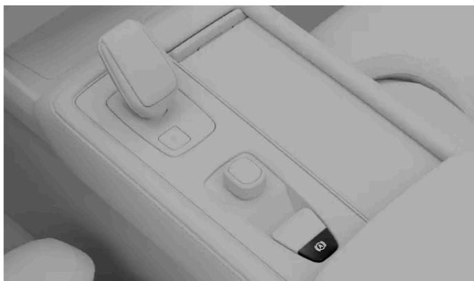
1 Prima o botão da retenção automática na consola de túnel.
