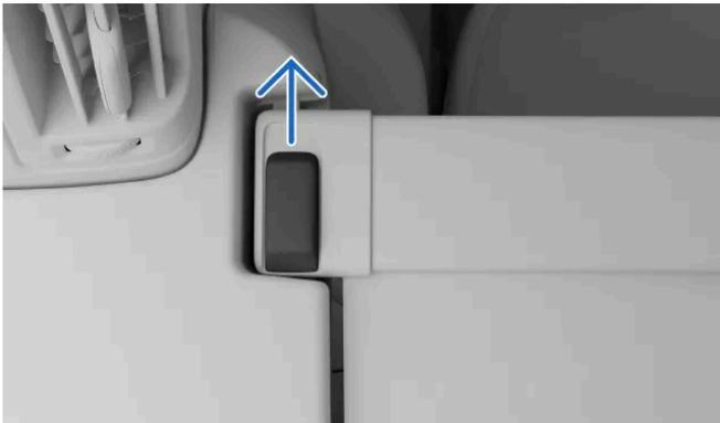
Existem botões de bloqueio nas extremidades da cobertura de carga. Empurre o botão num dos lados para a frente e segure-o enquanto levanta a extremidade da cobertura de carga. Proceda do mesmo modo na outra extremidade da cobertura de carga.
