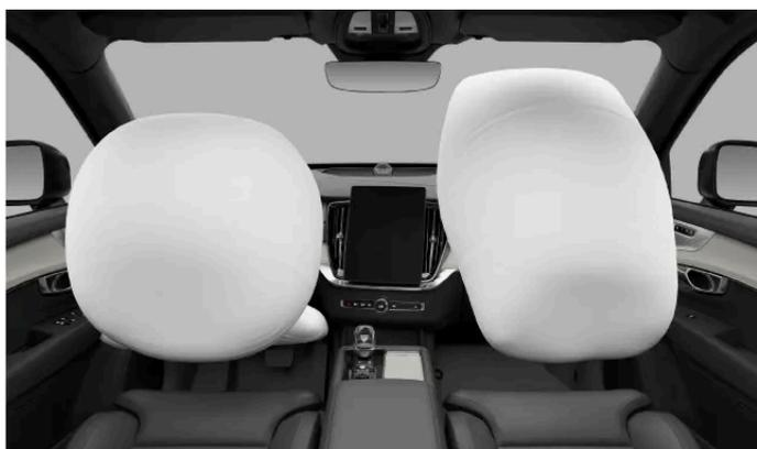
O lado do condutor tem dois airbags dianteiros. O airbag superior encontra-se acondicionado no interior do volante e o airbag do joelho atrás de um painel sob o volante.
