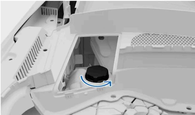
Desaperte a tampa do reservatório do líquido de arrefecimento.
