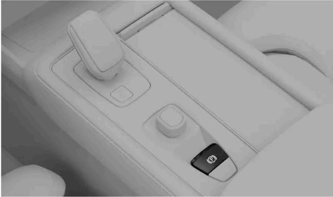
Acione manualmente o travão de estacionamento puxando o interruptor do travão de estacionamento.
