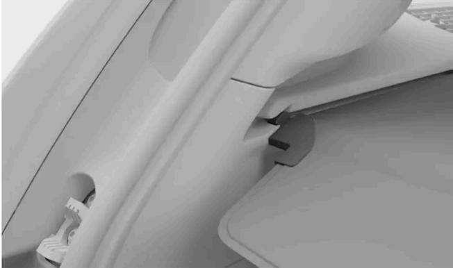
Levante e puxe a extremidade da tela da cobertura de carga pela pega para a desbloquear.
