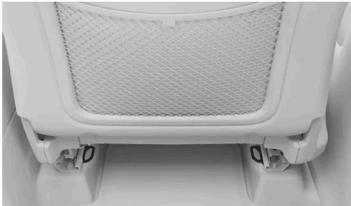
Os pontos de fixação do tirante inferior encontram-se na traseira das calhas do chão dos bancos dianteiros.
