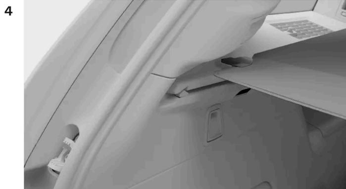
Deslize as extremidades da tela da cobertura de carga para as ranhuras superiores dos painéis laterais.
