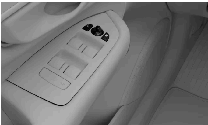
Comandos para ajuste dos retrovisores laterais
