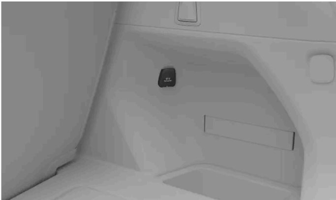
A toma elétrica de 12 V encontra-se no lado direito do porta-bagagens
