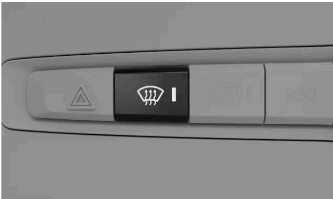
Butonul de degivrare max. din panoul de butoane de sub afișajul central
