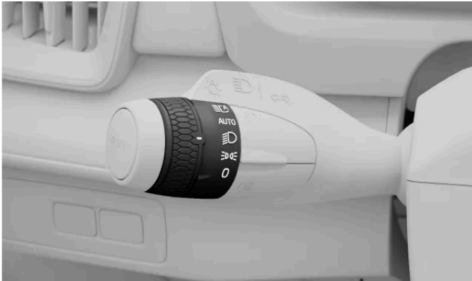
Simbolul pentru faza de întâlnire de pe inelul rotativ de pe maneta din stânga
