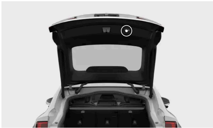
Locația butonului de închidere la portbagajului
