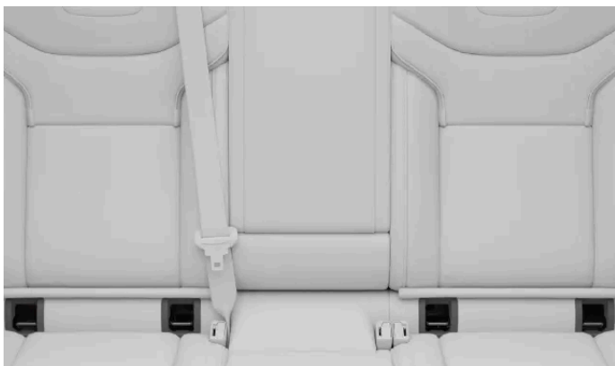
Locația punctelor de ancorare ISOFIX pentru bancheta spate
