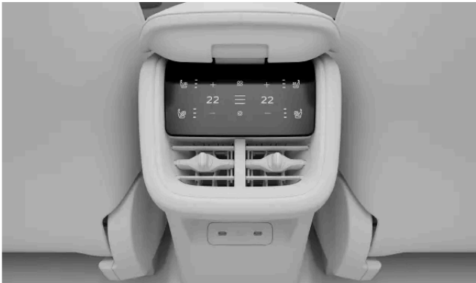
Comenzile climatizării în consola tunel
