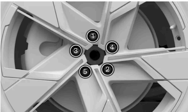
Strângeți șuruburile de roată în diagonală.
