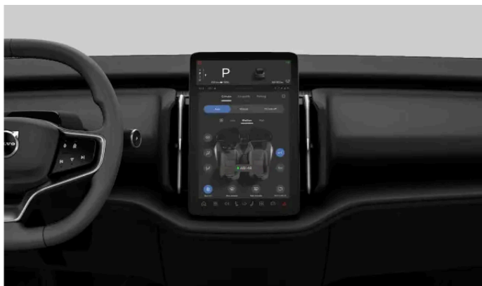
Comenzi de climatizare din afișaj
