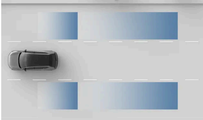
Zonele de detecție ale radarului.
