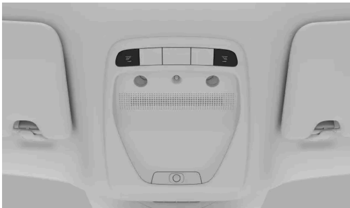
Lămpile de lectură pentru scaunul din față din consola superioară
