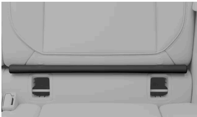
Clapeta ISOFIX pliată, ascunsă în spațiul de deasupra punctelor de ancorare
