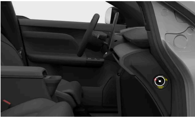
Locația comutatorului pentru airbagul pasagerului
