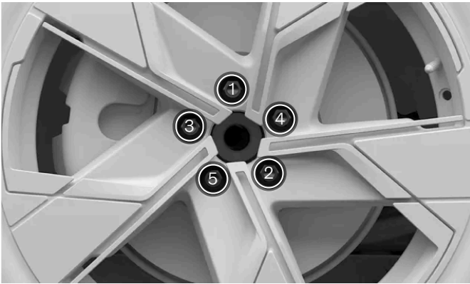
Strângeți șuruburile de roată în diagonală.
