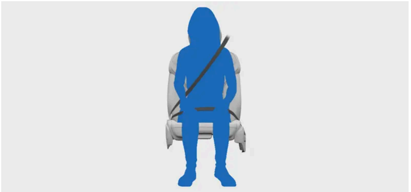
Centură de siguranță corect cuplată și reglată.
