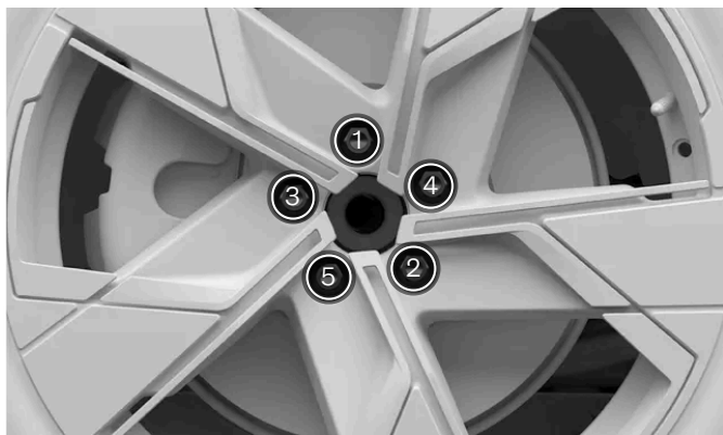
Strângeți șuruburile de roată în diagonală.
