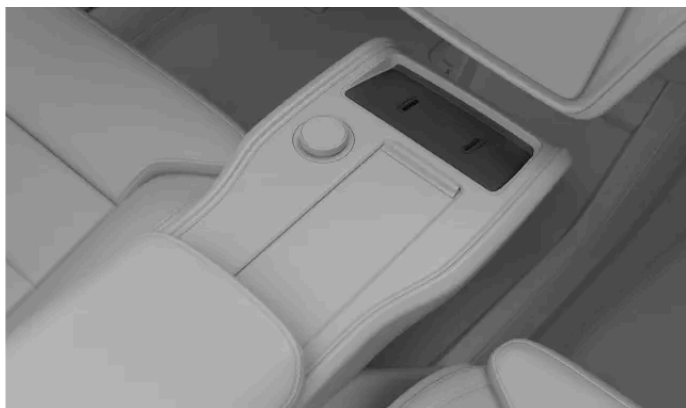
Cititorul de chei amplasat între scaunele față are și rolul de încărcător wireless.
