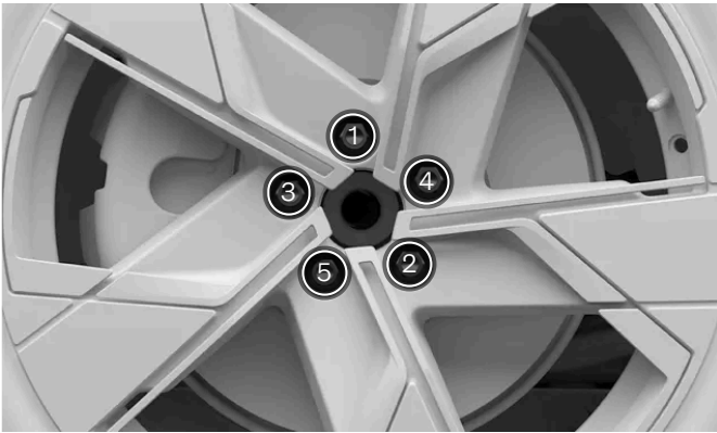
Strângeți șuruburile de roată în diagonală.
