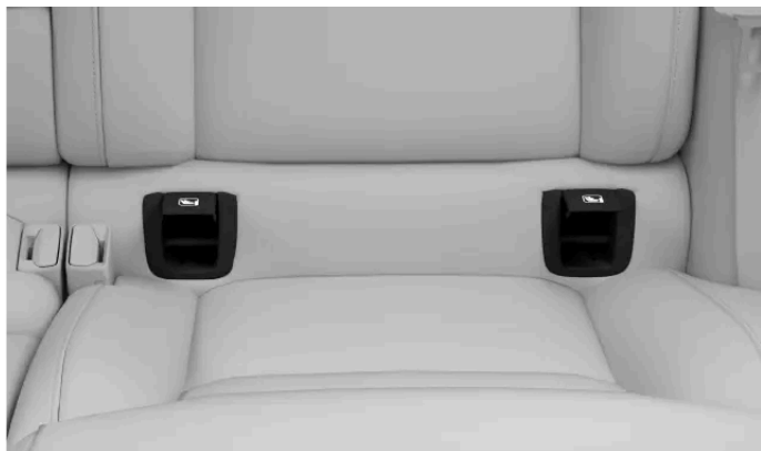
Locațiile punctelor de ancorare ISOFIX pentru scaunele spate exterioare
