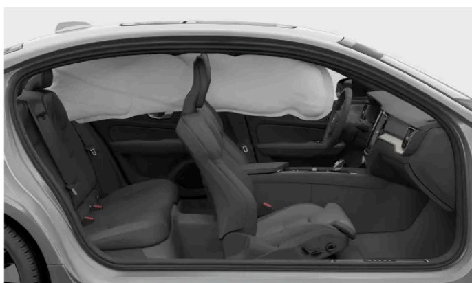
Airbaguri cortină declanșate pe o parte a mașinii.
