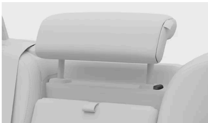
Buton de blocare de pe tetieră
