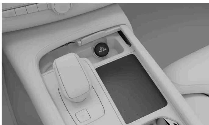
Priza de 12 V din consola tunel
