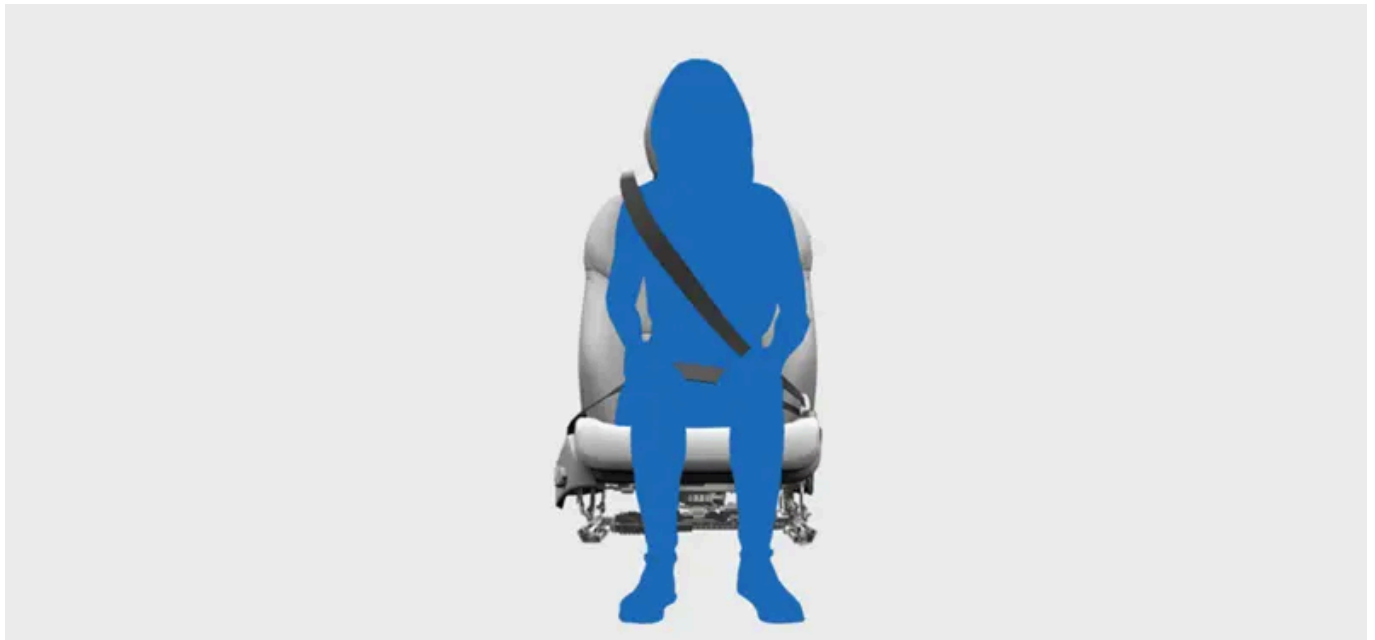
Centură de siguranță corect cuplată și reglată.
