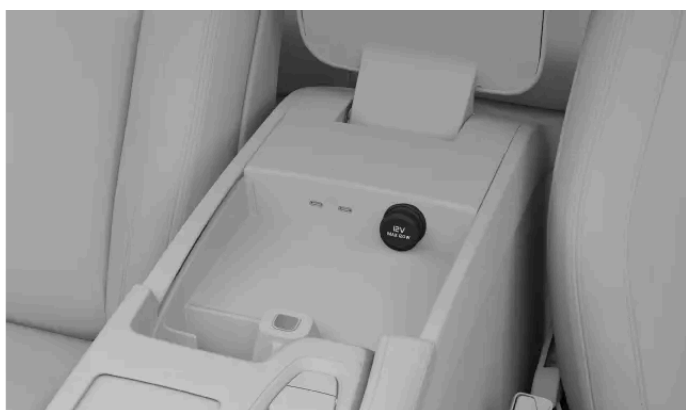
Priza electrică de 12 V din consola tunel
