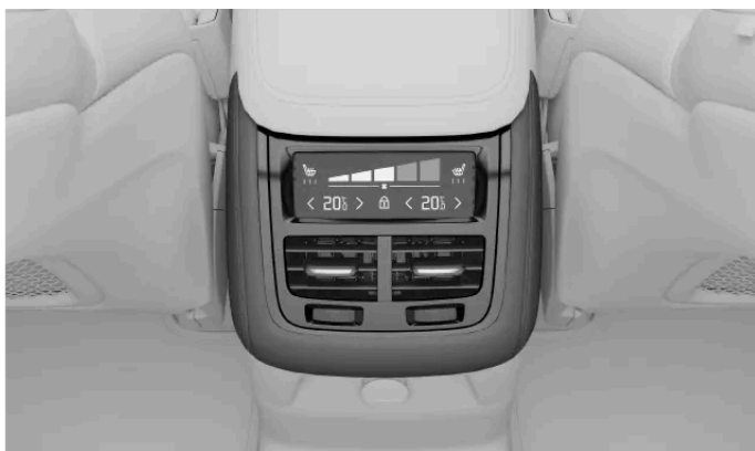
Comenzile climatizării în consola tunel
