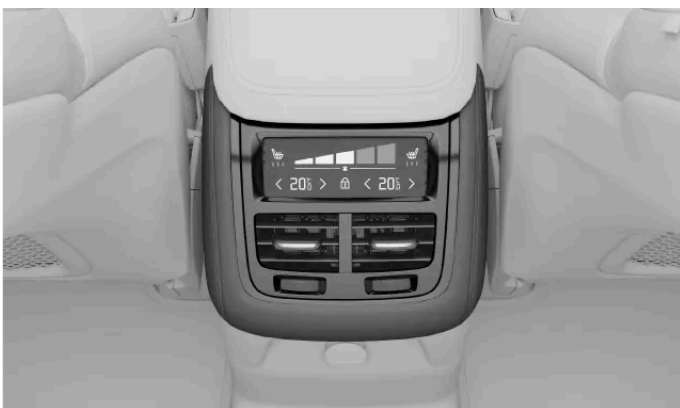
Comenzile climatizării în consola tunel
