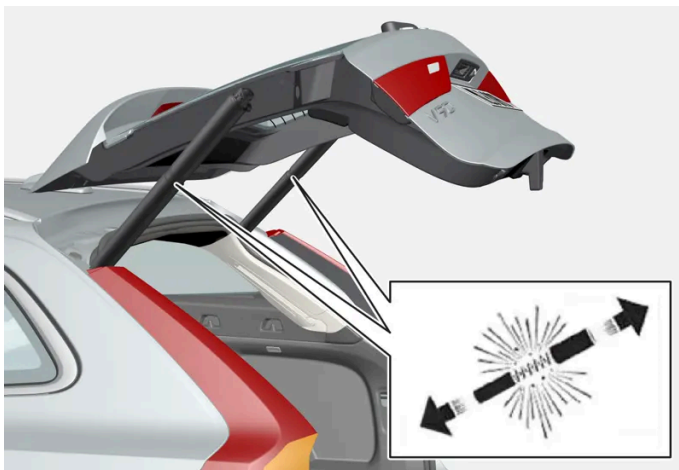
Tije telescopice pentru hayonul acționat electric.
