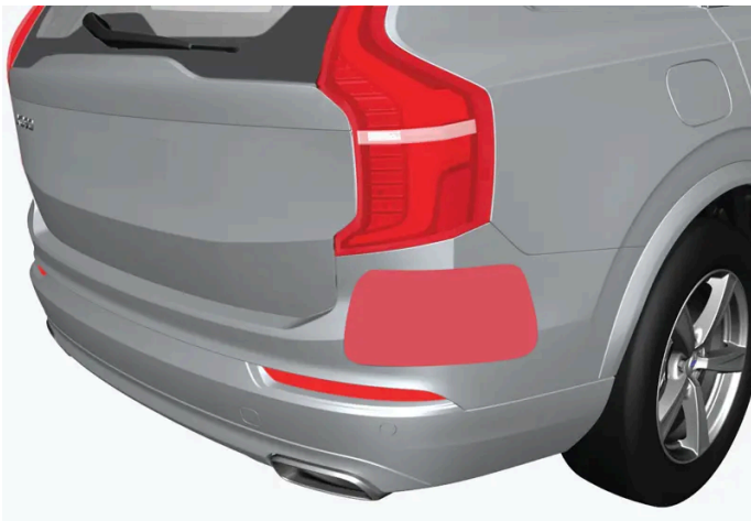
Locația unităților radar din spate
