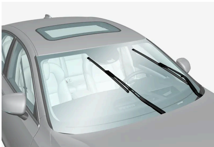
Lamelele ștergătoarelor în poziția de service.
