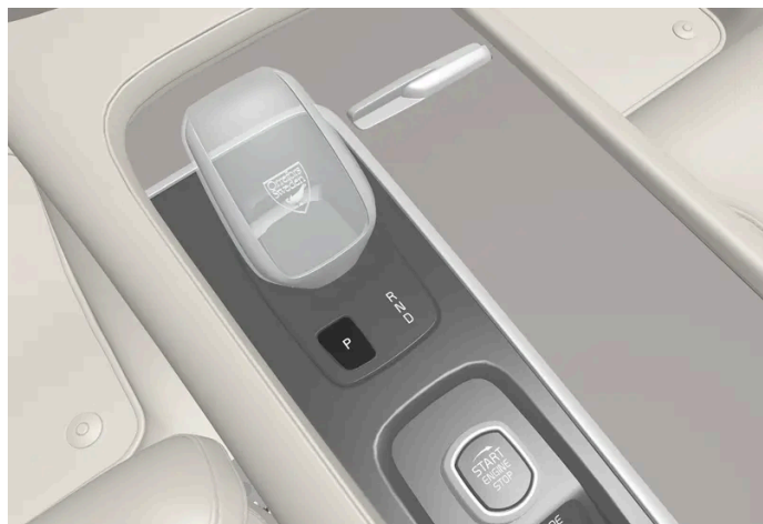
Prezentarea selectorului de viteze și a poziției P.
