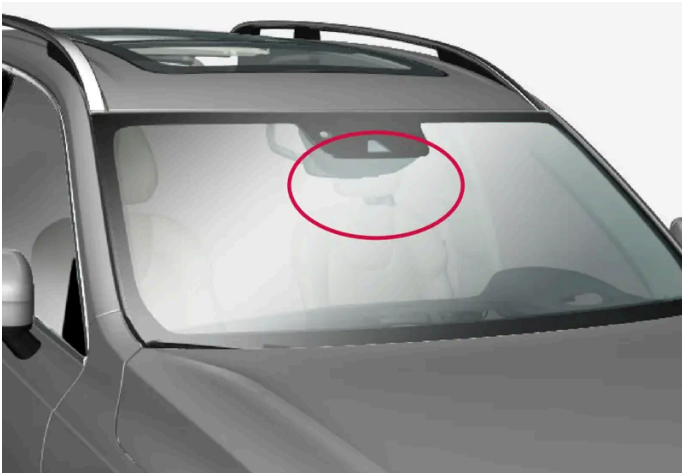
Locația camerei și unității radar din față
