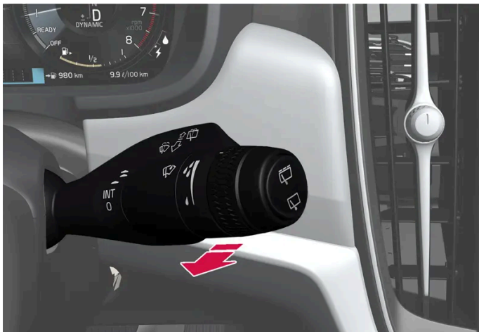
Funcția de spălare, maneta din dreapta
