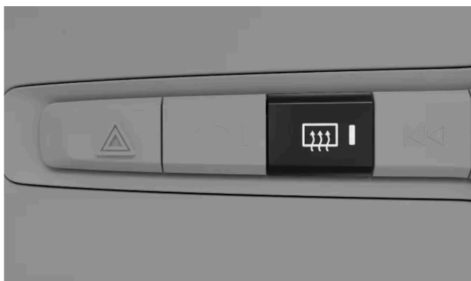
Butonul de degivrare a lunetei din panoul de butoane de sub afișajul central
