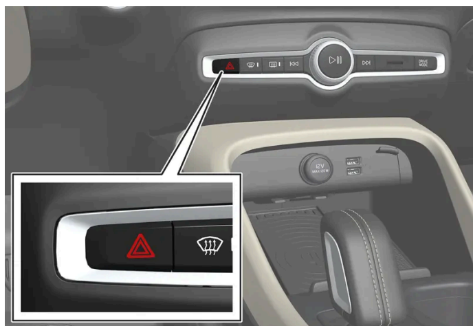
Buton pentru luminile de avarie.
