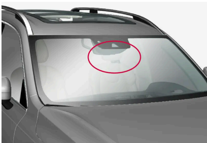
Locația camerei și unității radar din față
