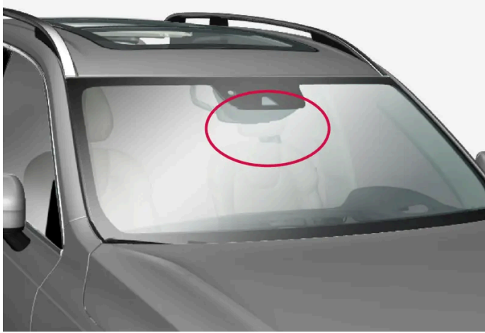
Locația unității radar din față
