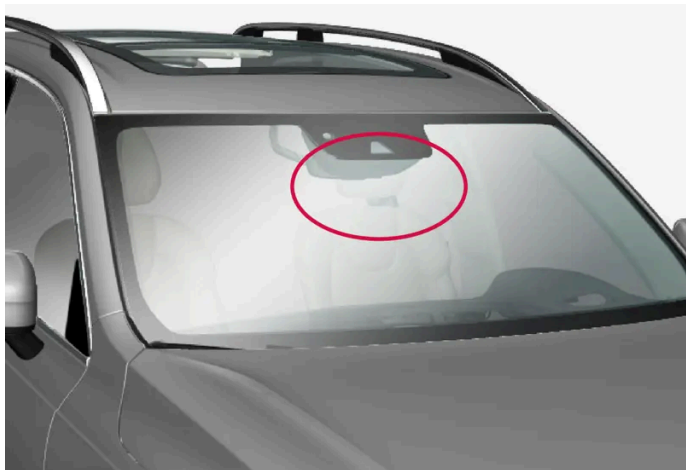
Locația camerei și unității radar din față
