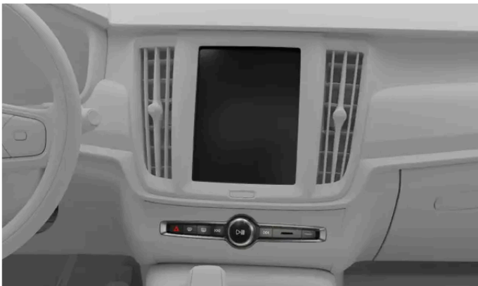
Afișajul central și butoanele de degivrare din panoul de butoane de sub afișajul central
