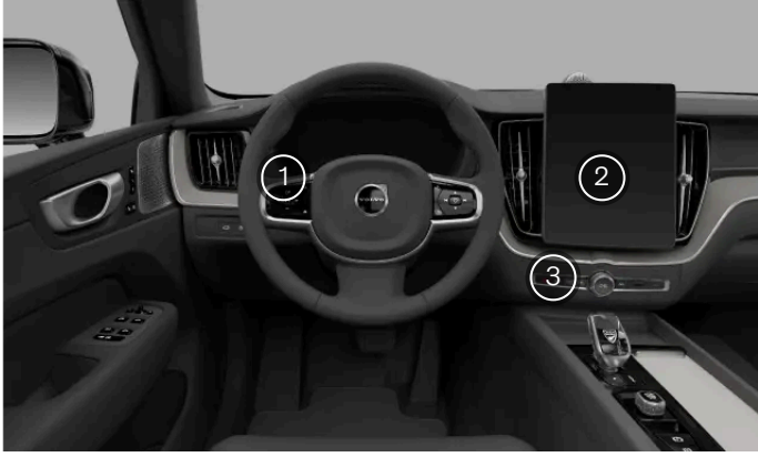
Locațiile comenzilor pentru luminile exterioare
