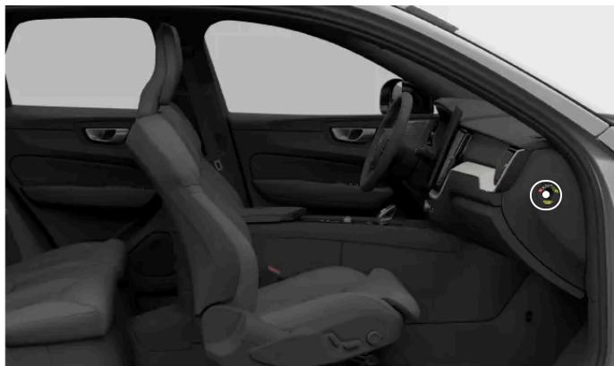
Locația comutatorului pentru airbagul pasagerului
