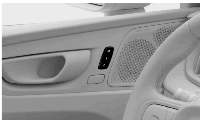
Locația butoanelor pentru reglaje prestabilite ale scaunului
