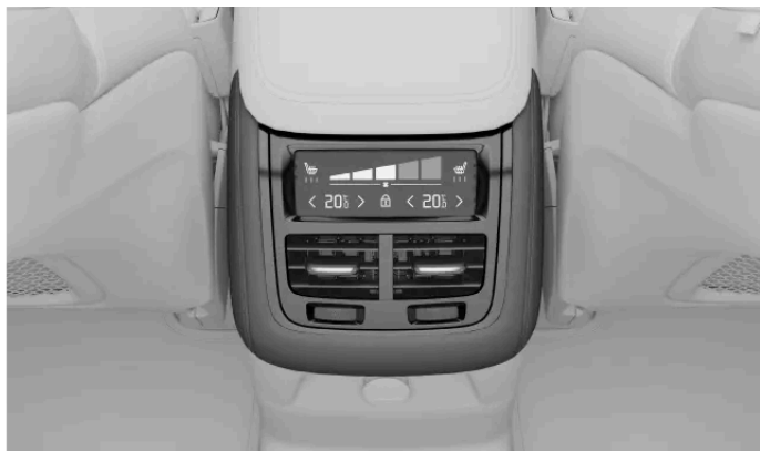
Comenzile climatizării în consola tunel
