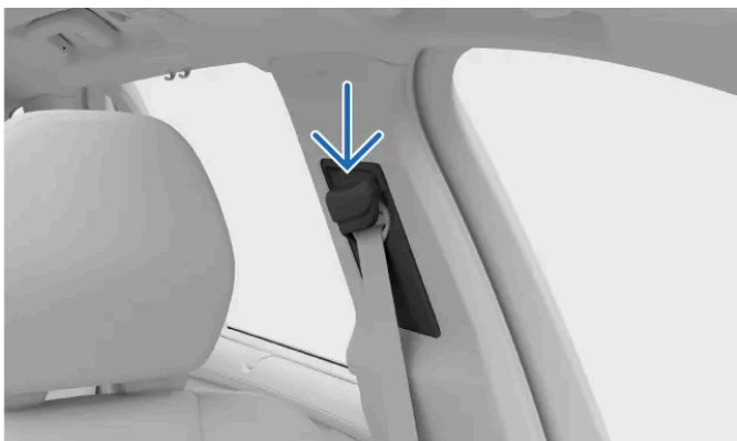
Punct de ancorare superior pentru centura de siguranță
