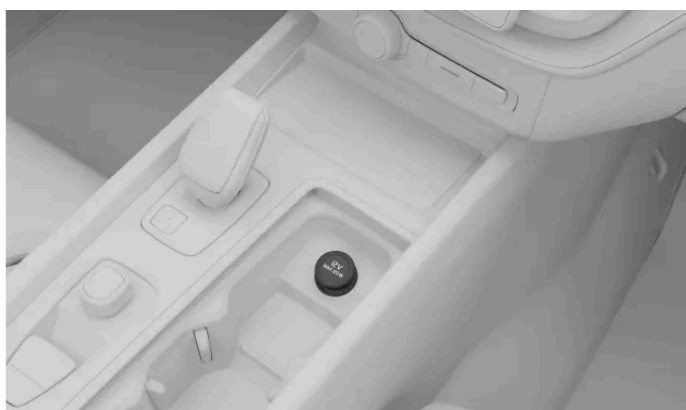
Priza electrică de 12 V din consola tunel
