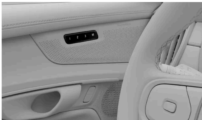
Locația butoanelor pentru reglaje prestabilite ale scaunului
