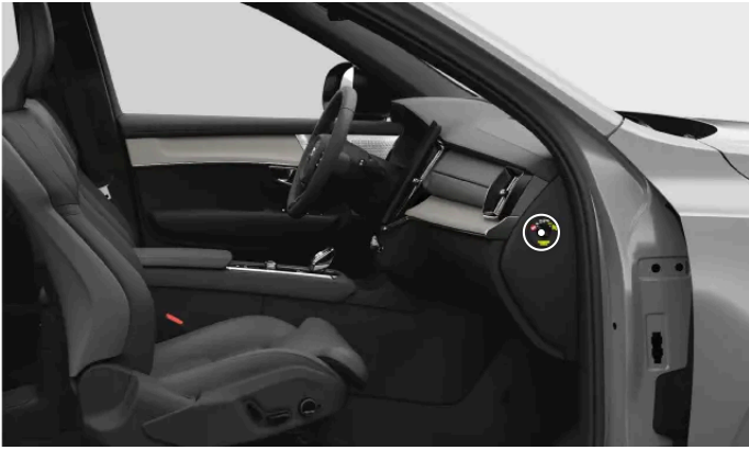
Locația comutatorului pentru airbagul pasagerului
