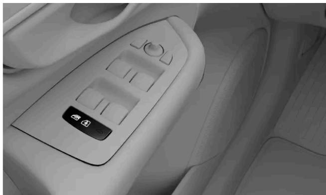
Locația butonului pentru încuietorile de protecție pentru copii din panoul portierei
