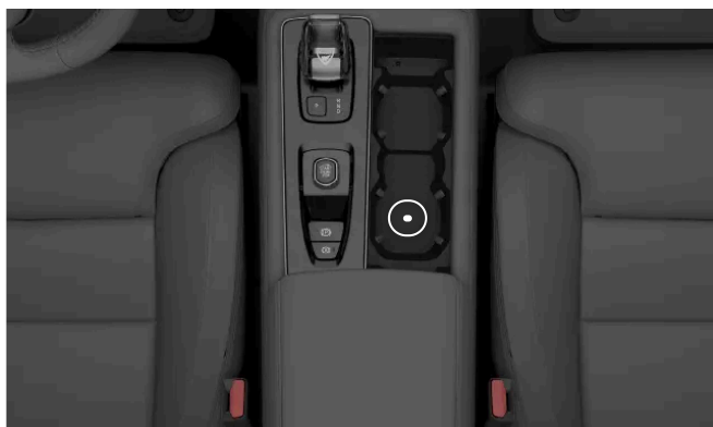
Locația cititorului de rezervă în interiorul suportului pentru pahare din consola tunel
