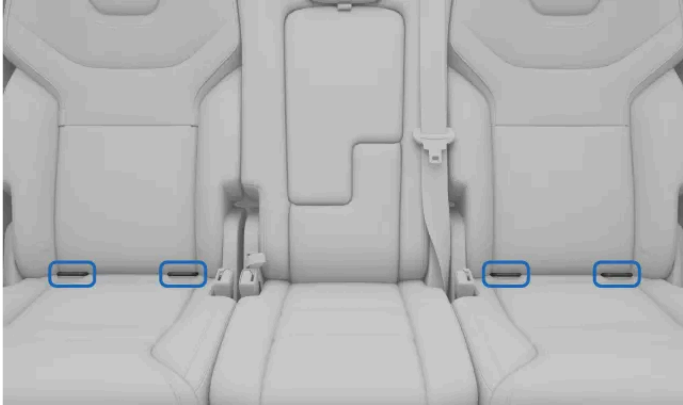
Locația punctelor de ancorare ISOFIX pentru cel de-al doilea rând de scaune
