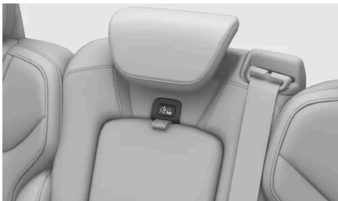
Buton de blocare de pe tetiera centrală
