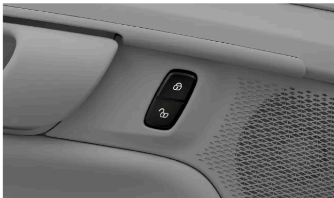
Buton pe portiera față pentru încuierea centralizată
